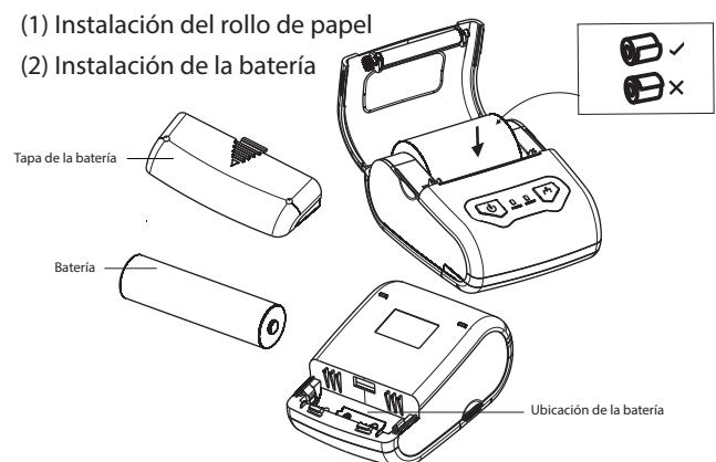
**⚠** Al instalar la batería, preste atención a distinguir entre los polos positivo y negativo; de lo contrario, no se encenderá o la máquina no se encenderá.
